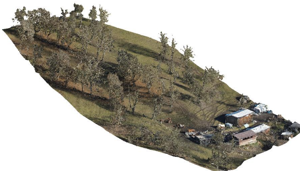
Nuvem de Pontos 1 – parte superior do talude obtida por fotogrametria
